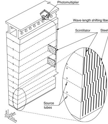
**Figure 2:** Tile module wedge [1]
